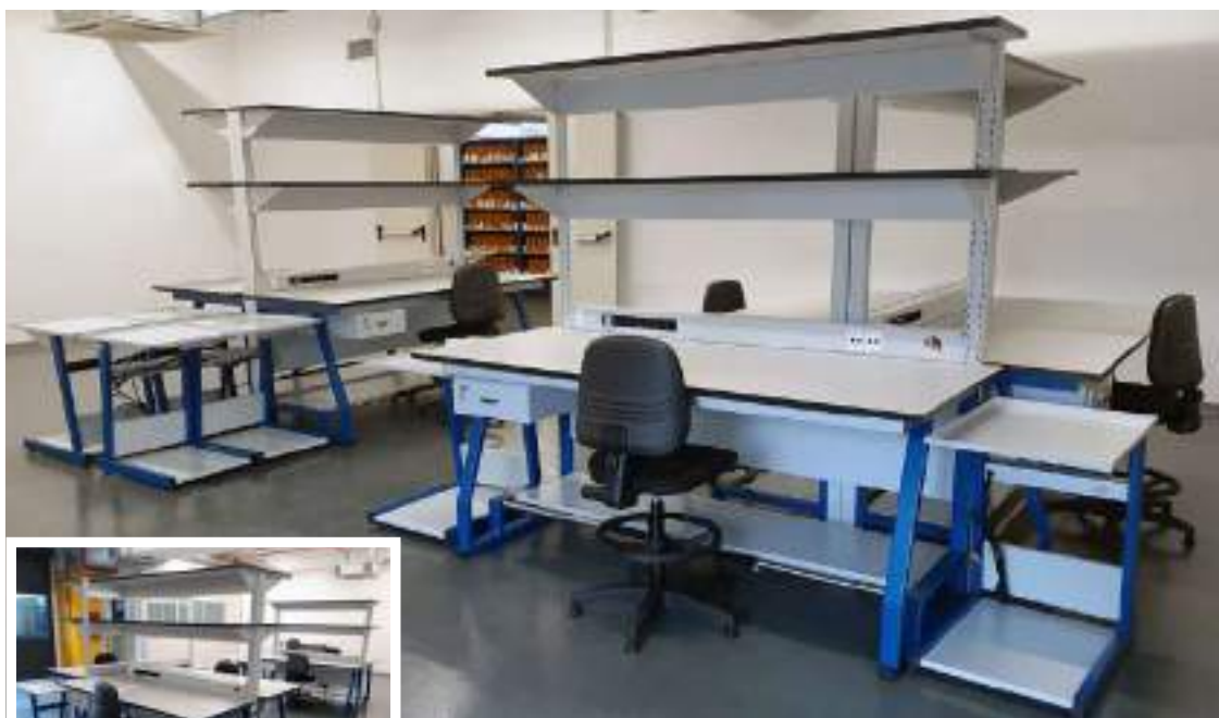
Allestimento tecnico con banchi di lavoro contrapposti e carrelli elettrificati.
